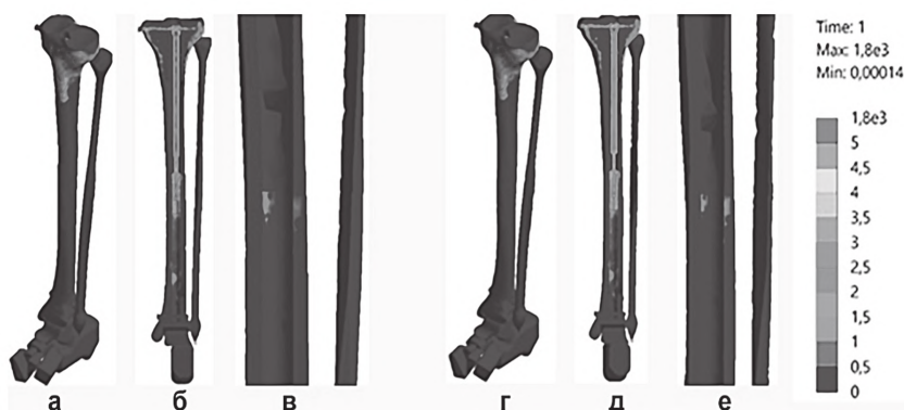
Рисунок 7 – Розподіл напружень в моделях під впливом навантаження на кручення. Остеосинтез стрижнем без ротаційної стабільності: а – загальний вид; б – розтин великогомілкової кістки; в – зона перелому. Остеосинтез стрижнем з ротаційної стабільністю: г – загальний вид; д – розтин великогомілкової кістки; е – зона перелому.
