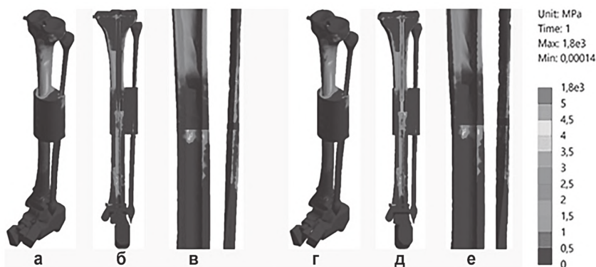
Рисунок 9 – Розподіл напружень в моделі під навантаженням на кручення. Блок з кісткових трансплантатів на обидві кістки: Остеосинтез стрижнем без ротаційної стабільності: а – загальний вид; б – розтин великогомілкової кістки; в – зона перелому. Остеосинтез стрижнем з ротаційної стабільністю: г – загальний вид; д – розтин великогомілкової кістки; е – зона перелому.
